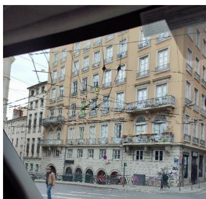
L'implantation de lignes aériennes engendre des difficultés d'accès en façade lors du déploiement de la grande échelle.
