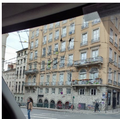
Figure 1: « Toiles d'araignée » de lignes aériennes de bus, gênant le positionnement de l'échelle à Croix-Rousse, Lyon. Source : SDMIS 69
