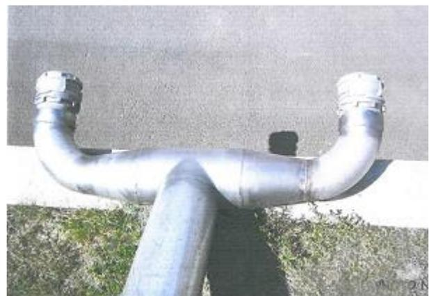
Exemple de 2 prises de 100 mm de diamètre sur une colonne d'aspiration de 150 mm de diamètre
